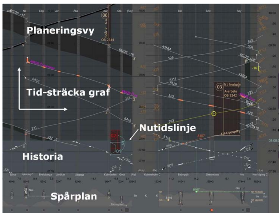
Figur 8. Ett exempel på ett STEG-gränssnitt. Den övre delen av bilden är planeringsvy i form av en tid-sträckagraf. Den scrollar neråt mot nutidslinjen vartefter tiden går. Under nutidslinjen finns historien. Den aktuella planen för alla tåg inom området finns visade i grafen. Det mesta av den observerbarhet och styrbarhet som behövs i det operativa arbetet finns i detta helt integrerade gränssnitt. Så är t ex all banarbeten, relevant tåginformation, förenklade spårplaner med tågens position, banprofiler m.m. inkluderade. För att stödja beslutsfattandet identifieras och visas alla konflikter, förseningar m.m.
