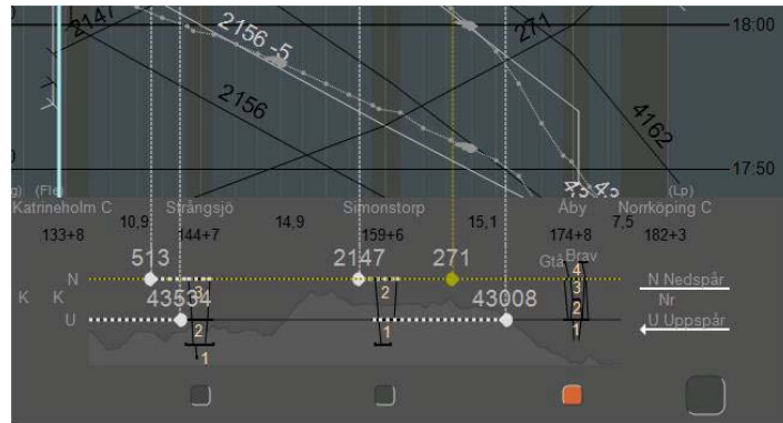
Figur 11. Den orangea markeringen indikerar att den automatiska exekveringen (AEF eller PEF) inte är i funktion på denna driftplats. Saknas markeringen kommer planen att exekveras automatiskt då planen närmar sig realtid. Exakt när den exekveras, och hur långt en tågväg då låses, visas också i gränssnittet.
